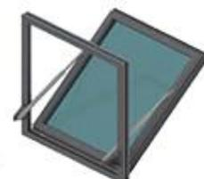
Le châssis est équipé en partie haute d'un ou deux boîtiers à chaîne. Discrètement intégré sur le profil, le boîtier à chaîne est positionné en partie haute pour les abattants et sur le côté pour les battants, selon le sens d'ouverture.
